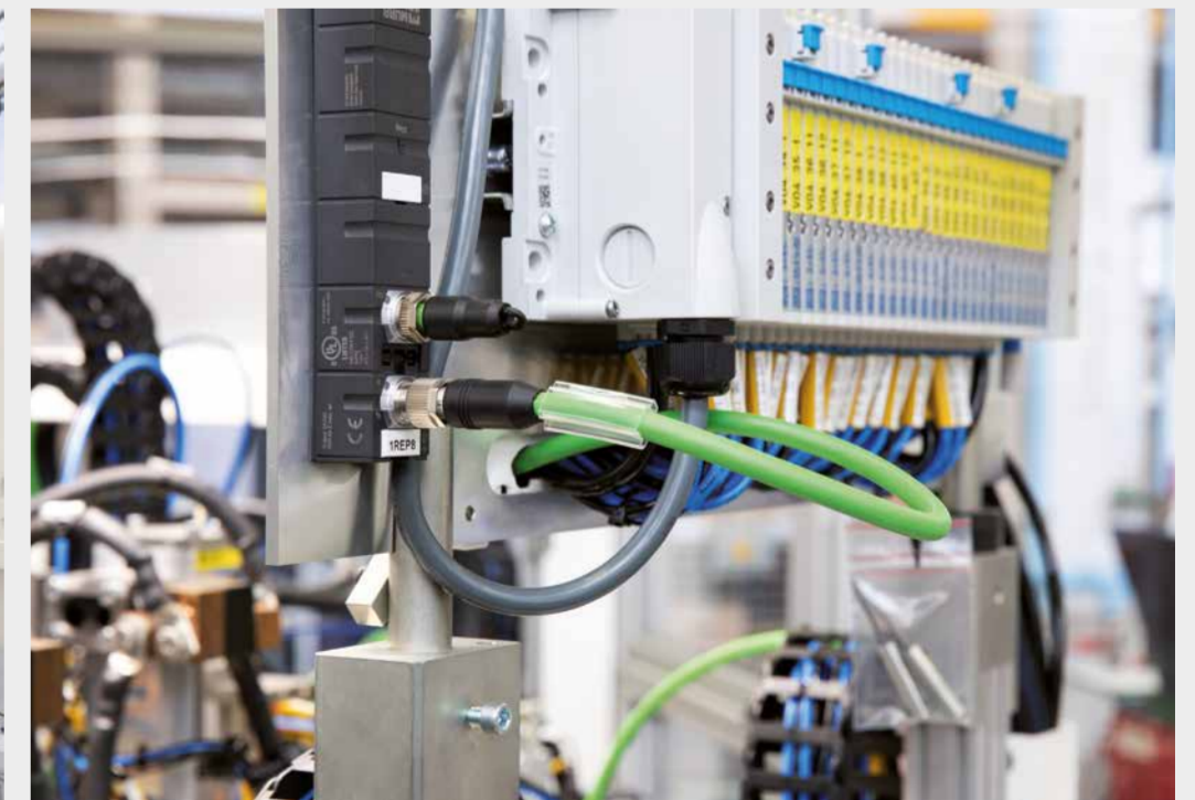
Mit den Cube67-Ventilinselanbindungen (Multipolstecker) können Ventile auf einfache Weise direkt vor Ort angesteuert werden.
