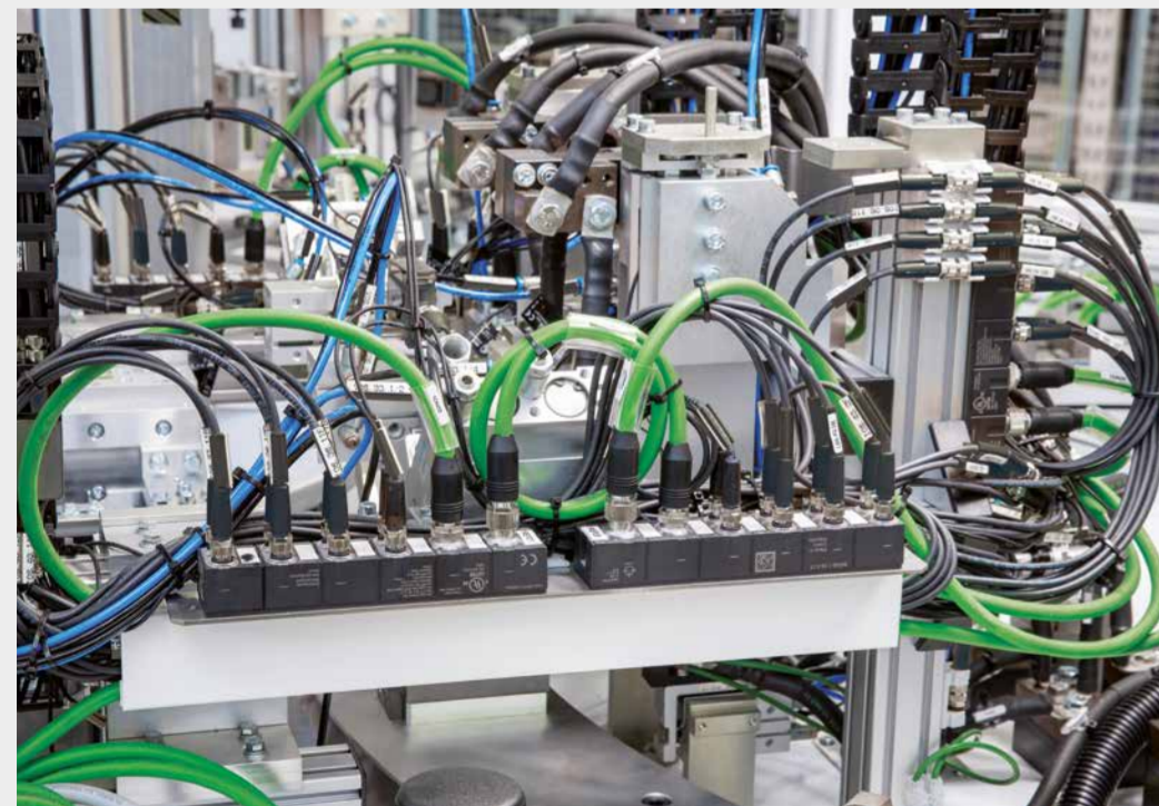
Die Elektrokonstruktoren können für jeden Steckplatz entscheiden, ob sie ihn als Eingang oder als Ausgang nutzen wollen – und können aus Standardmodulen somit „maßgeschneiderte“ Mischmodule machen.
