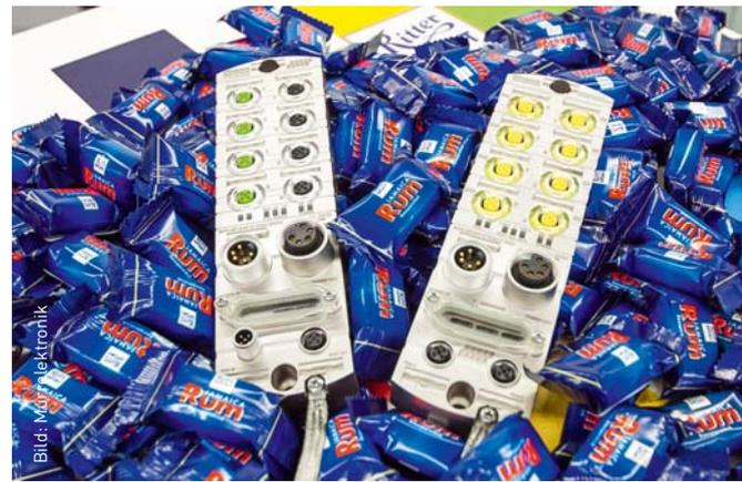
Dazu haben sie das sichere Feldbusmodul MVK Metall Safety in der Anlage integriert; es ermöglicht, sicherheitsrelevante Daten direkt über Profisafe zu übertragen. Die Elektrokonstrukteure mussten so nicht mehr passiv in den Schaltschrank verdrahten und erreichen dennoch höchste sicherheitstechnische Standards (SIL3 und PLe). ↓
