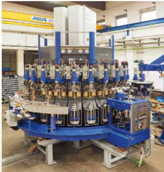
Das Maschinenbauunternehmen iPROtec GmbH setzt bei der elektrischen Installation einer neuen Rundtaktmaschine für die Glasherstellung auf das Cube-System von Murrelektronik. Aktoren und Sensoren werden dadurch effektiv in das Installationskonzept eingebunden.
