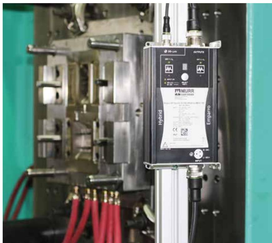
Emparro67 Hybrid verfügt über eine IO-Link-Schnittstelle (M12-Anschluss) und kann als Device mit einem übergeordneten IO-Link-Master kommunizieren. So ist es möglich, Emparro67 Hybrid in durchgängig vernetzten intelligenten Anwendungen einzusetzen. Ein konkretes Anwendungsbeispiel ist die Überwachung der Lebensdauer des Gerätes. Unternehmen im Anlagen- und Maschinenbau können derartige Predictive-Maintenance-Funktionen nutzen, um neue Geschäftsmodelle zu entwickeln.
