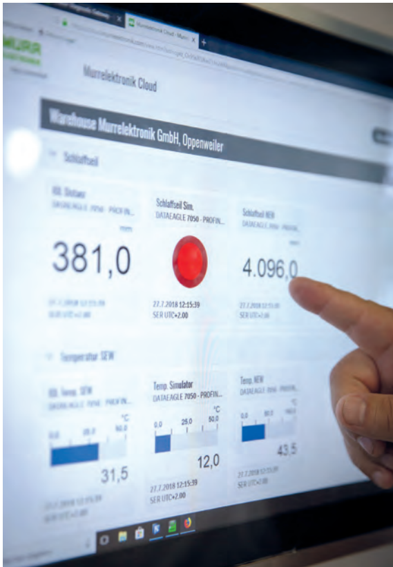
Auf dem Bildschirm werden alle Prozessdaten des Cube-Netzwerks ausgegeben, wie zum Beispiel die Schaltzustände der einzelnen Ein- und Ausgänge, Zählerstände oder Alarme
